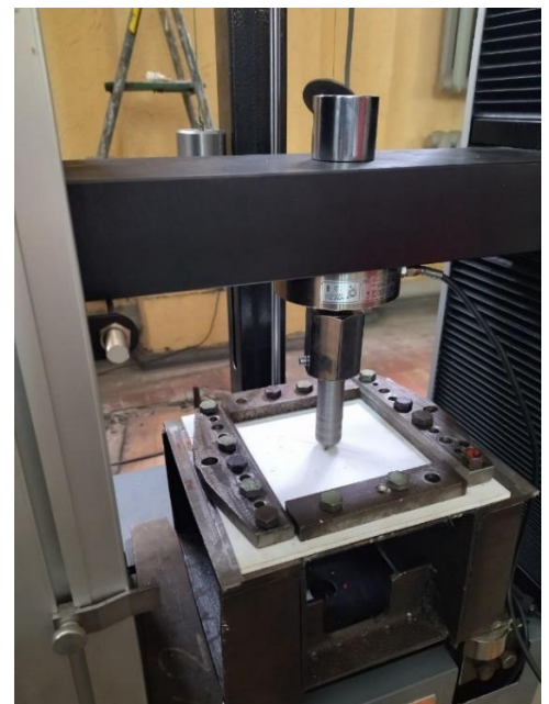
Рисунок 1.2 – Проведение испытаний пластины на изгиб
