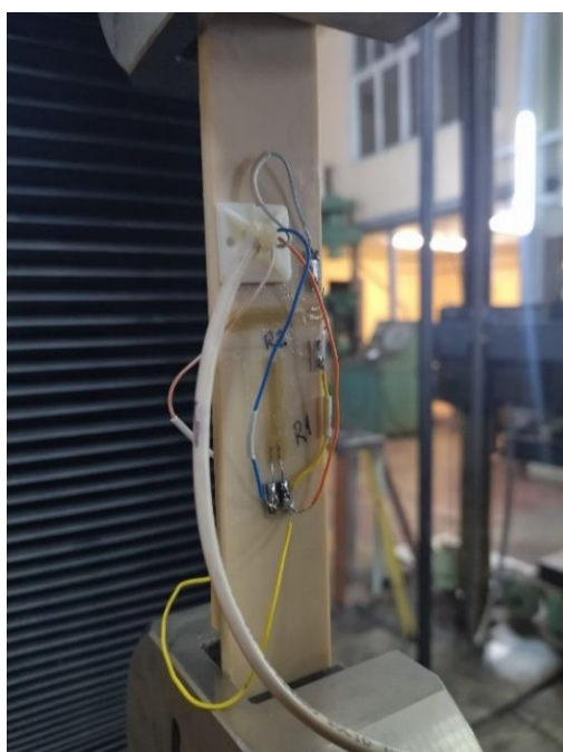
Рисунок 2.5 – Образец из НПВХ ВХЗ с наклеенными тензорезисторами для определения коэффициента Пуассона
