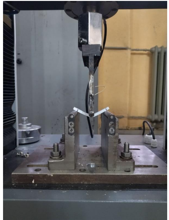
Рисунок 3.13 – Проведение испытаний на изгиб
