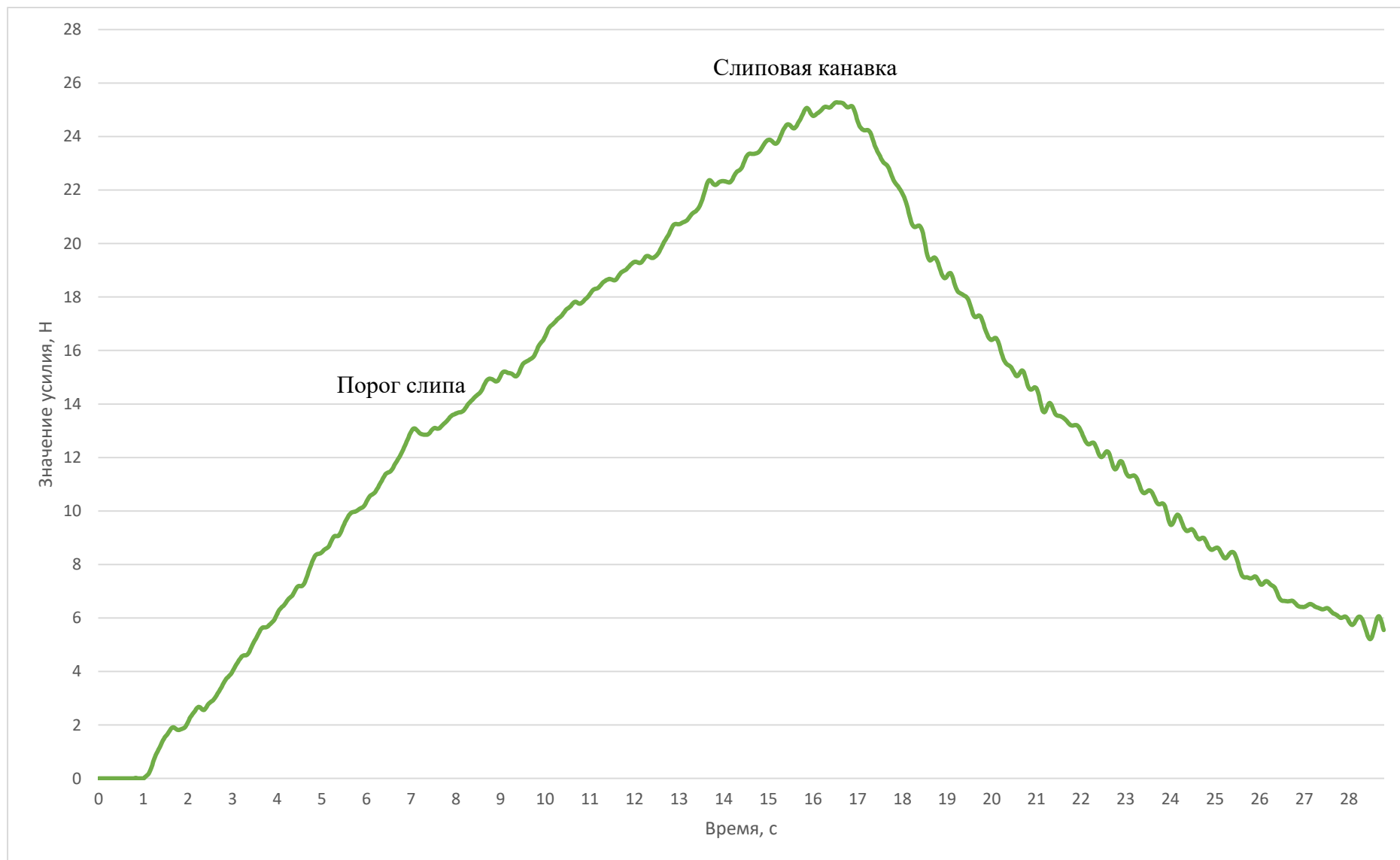
Рисунок П.В.5 – Динамограмма усилия выборки мешка на макетной установке по слипу сферической формы с углом наклона 30^\circ и скоростью выборки 0,048 \text{ м/с}
