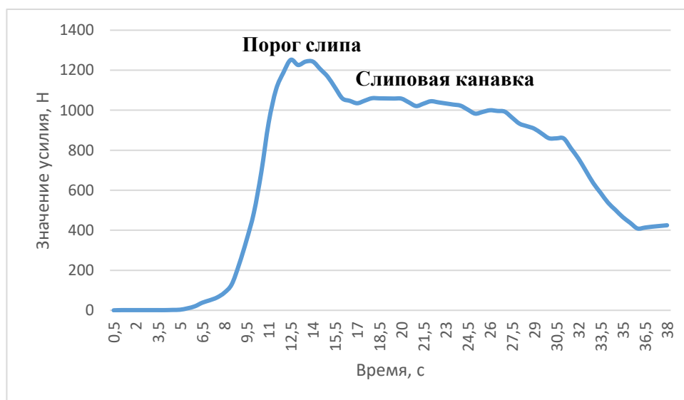
Рисунок 4.7 – Динамограмма изменения усилия, возникающего в вытяжном конце во время выборки кутка мешка с уловом на палубу судна при проведения 6-го замера
