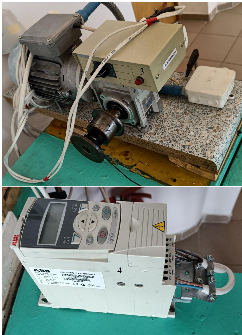
Рисунок 2.6 – Лебёдка макетной установки:
