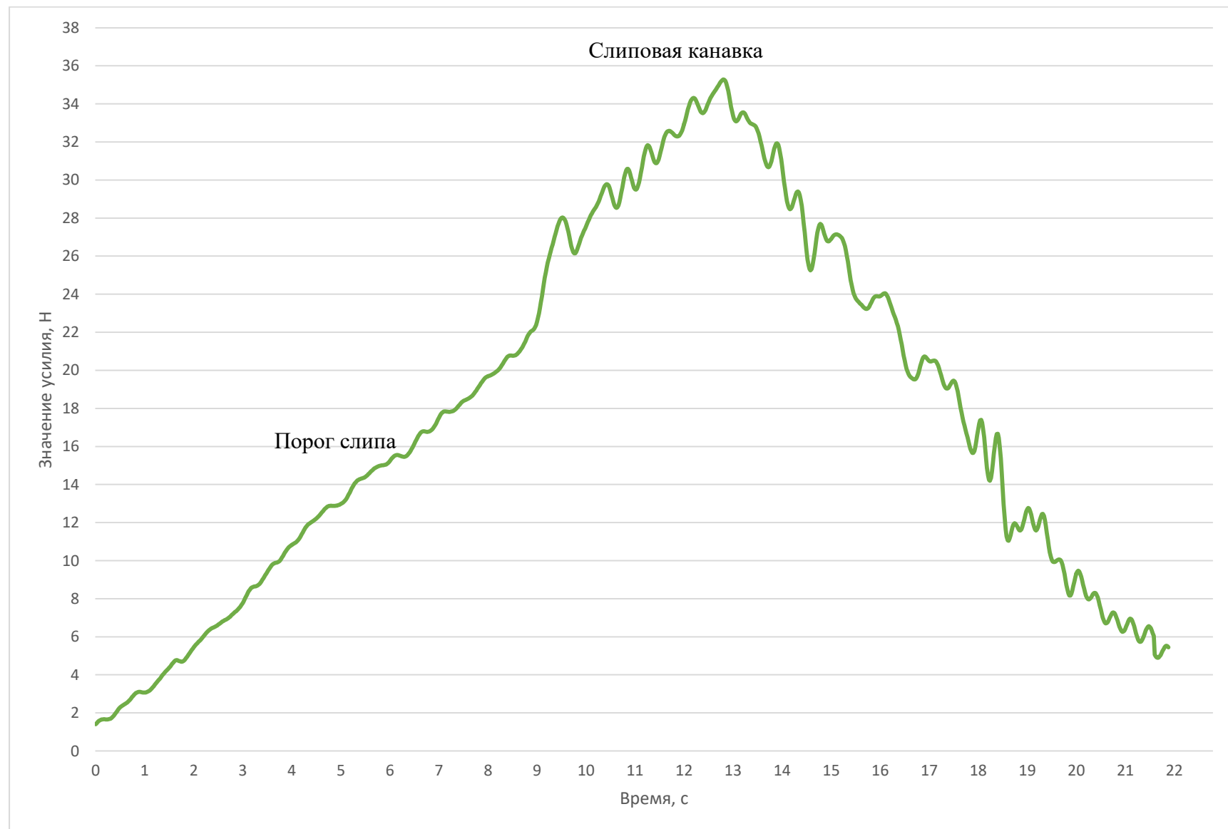
Рисунок П.В.12 – Динамограмма усилия выборки мешка на макетной установке по слипу прямолинейной формы с углом наклона 45^\circ и скоростью выборки 0,064 м/с
