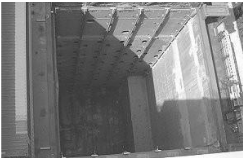
Рис. 1.7 Направляющие в трюме для установки контейнеров
