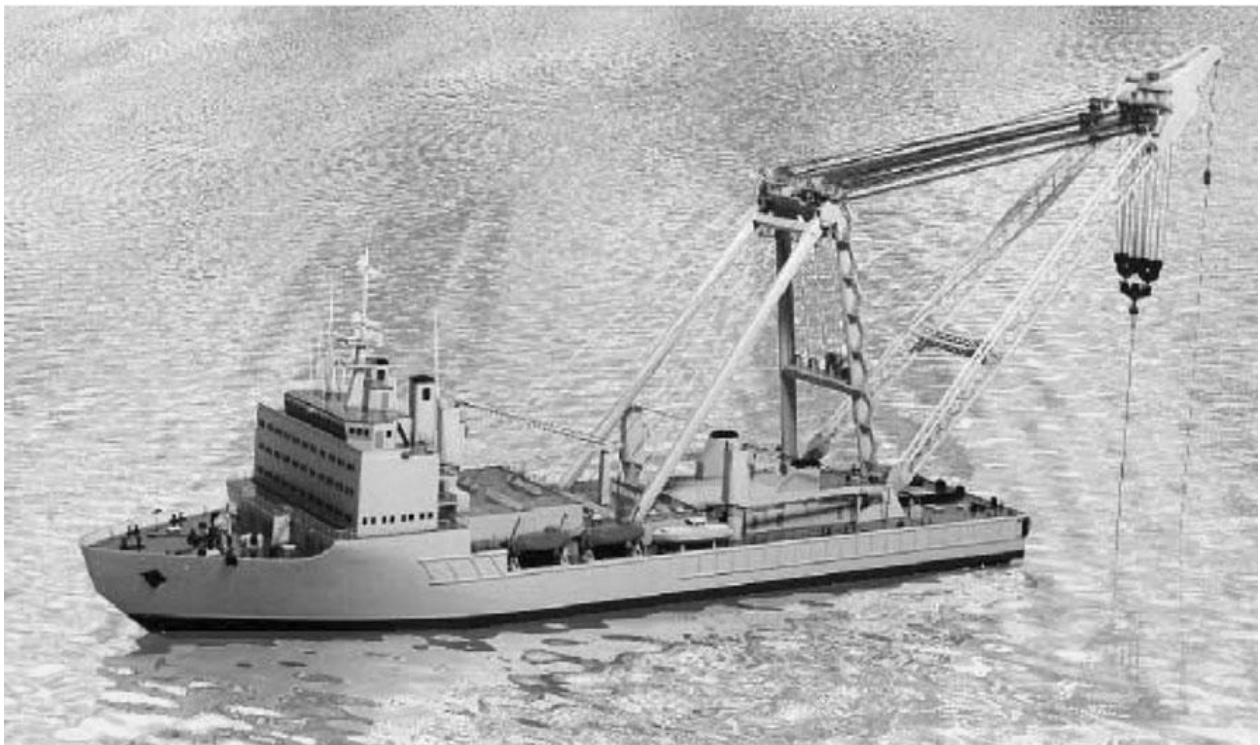
Рис.2.17 Специальное крановое судно
