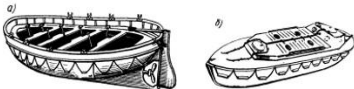
Рис. 3.13 Спасательные шлюпки а - открытая; б - закрытая
