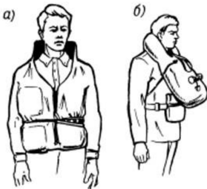
Рис. 3.15 Индивидуальные спасательные средства а - жесткий спасательный жилет, б - надувной спасательный нагрудник
