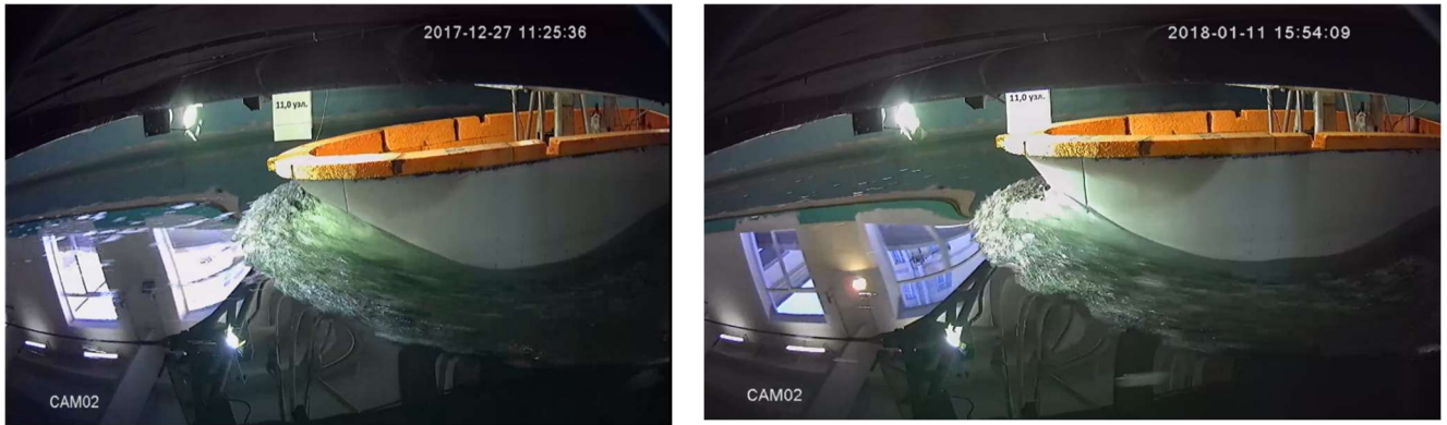
Рисунок 10 – Влияние угла дифферента на обтекание носовой оконечности судна на скорости 11 узлов при одинаковом водоизмещении ( F_r=0,39 ) в первом (слева) и во втором (справа) случаях загрузки
