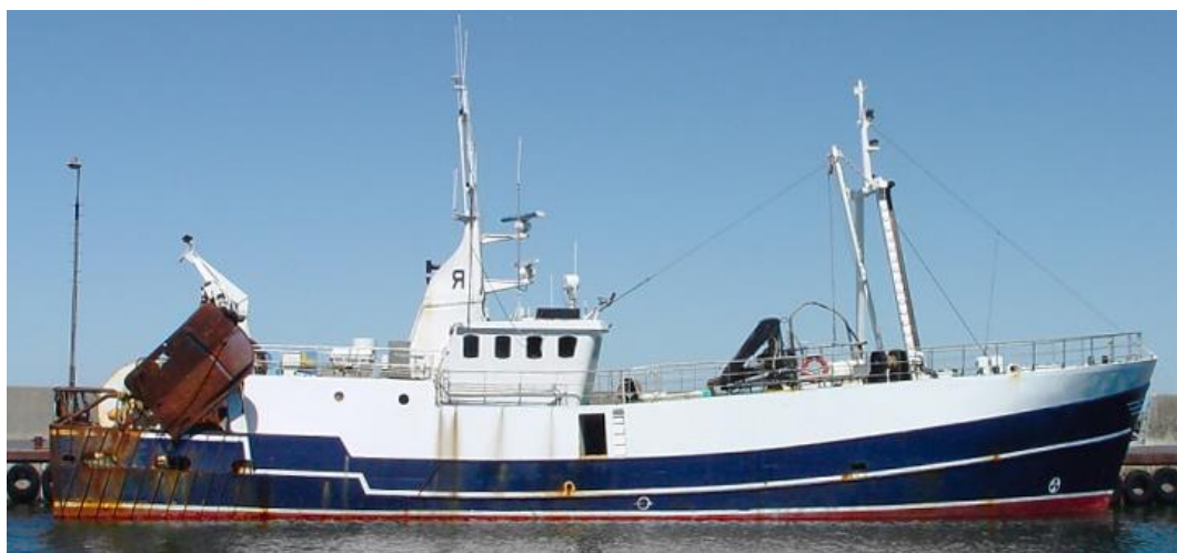
Рисунок 2.3.1 – Боковой вид промыслового судна с близким к оптимальному АКТ для пелагического промысла
