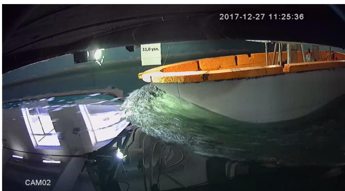
Рисунок 3.2.4 – Испытания МРТК «Адомат» в 1-ом случае нагрузки. Вид сбоку.
