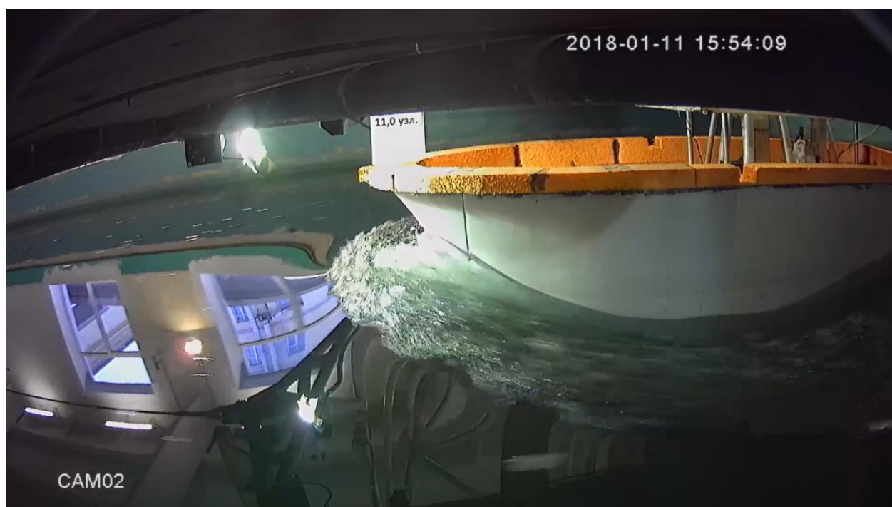
Рисунок 3.2.5 – Испытания МРТК «Адомат» в 2-ом случае нагрузки. Вид сбоку. Скорость 11 узлов
