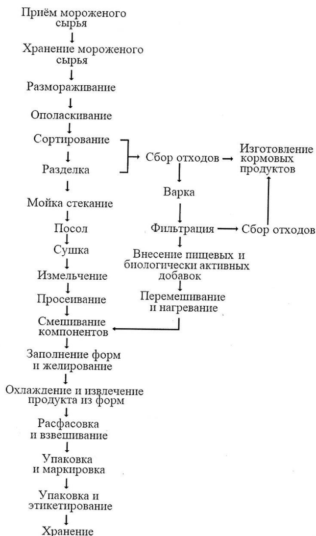
Рисунок 2.1 – Технологическая схема «Формованного структурата из морепродуктов»
