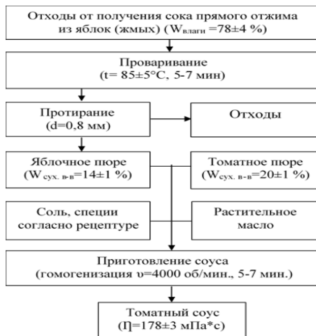
Рисунок 8 - Технологическая схема производства соуса
