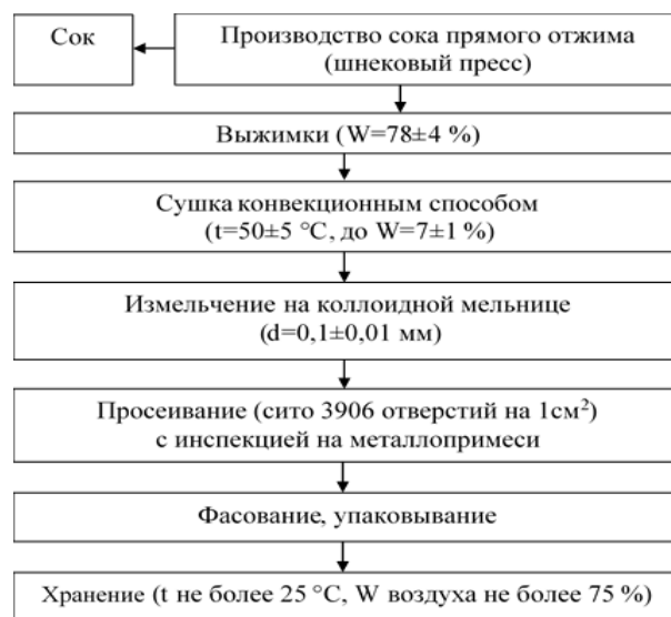
Рисунок 2 – Технологическая схема производства растительных порошков
