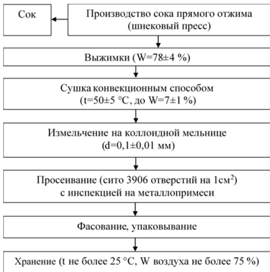
Рисунок 3.3.1 – Технологическая схема производства растительных порошков
