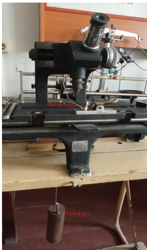
Рисунок 20 – Окулярный микроскоп с закрепленным образцом
