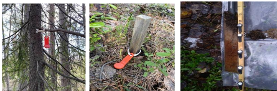
Рисунок 2.8 – Установка термохронов для измерения температуры воздуха, поверхности почвы, и почвенного профиля на глубинах 5 см (подстилка), 10, 15, 20 и 40 см
