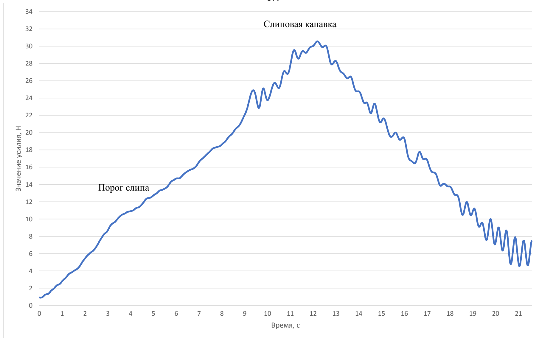
Рисунок П.В.9 – Динамограмма усилия выборки мешка на макетной установке по слипу прямолинейной формы с углом наклона 30^\circ и скоростью выборки 0,064 м/с
