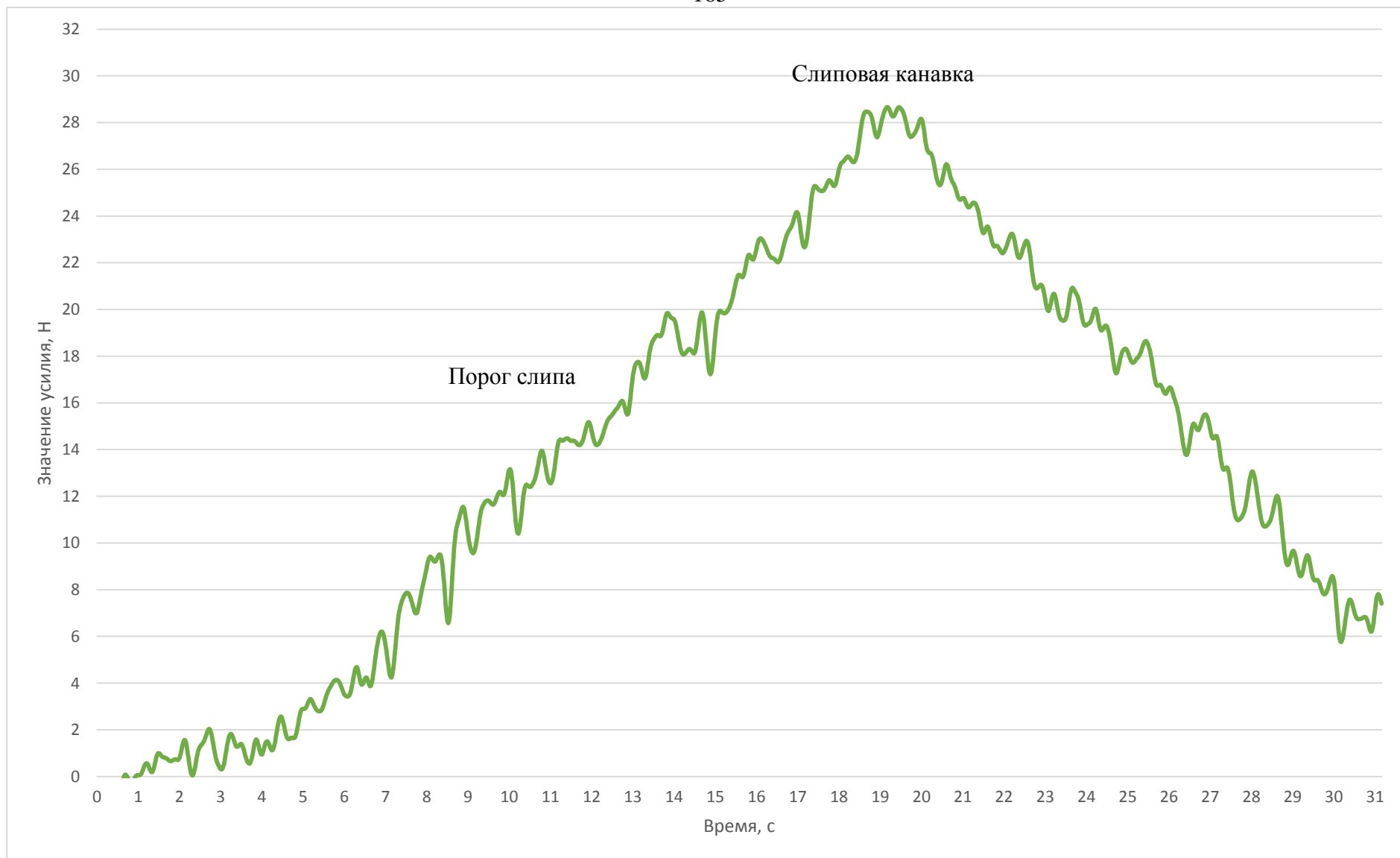
Рисунок П.Б.11 – Динамограмма усилия выборки мешка массой 2,0 кг на макетной установке по слипу прямолинейной формы с углом наклона 45^{\circ} и угле выхода вытяжного конца 5^{\circ}
