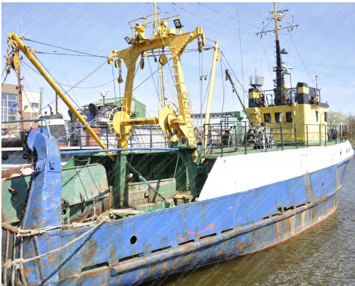
Рисунок 1.5 – Основные элементы бесслипового промыслового устройства кормового траления с полным подъёмом трала на сетевой барабан, расположенный на высоком портале:
