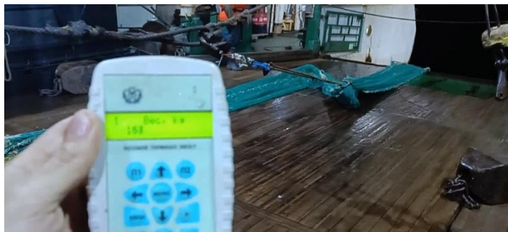
Рисунок 4.6 – Замер усилия во время выборки
