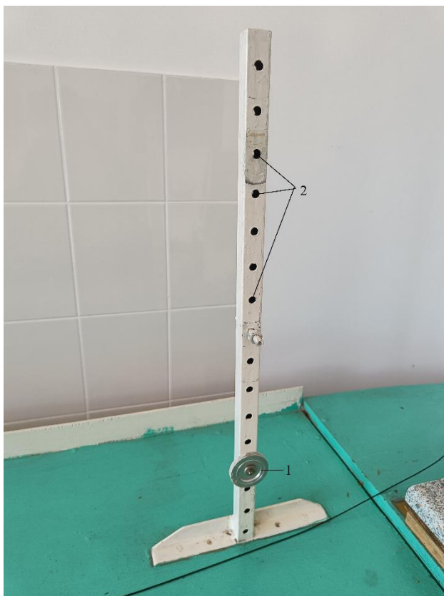
Рисунок 2.5 – Стойка крепления направляющего блока: 1 – направляющий блок; 2 – отверстия для фиксации блока вытяжного конца
