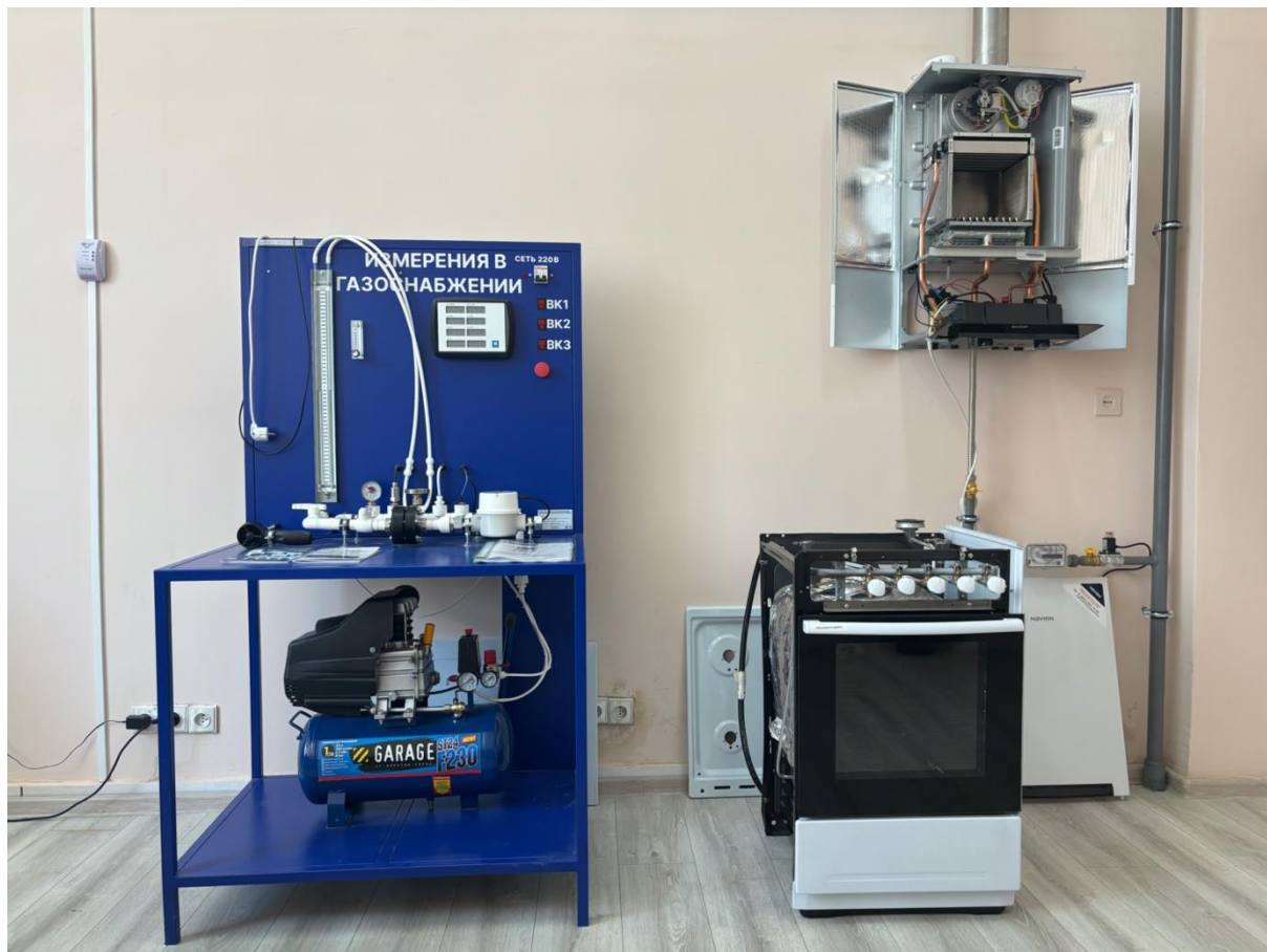
Лабораторный стенд "Измерения в газоснабжении", образцы двухконтурного котла и четырехконфорочной газовой плиты с духовкой
