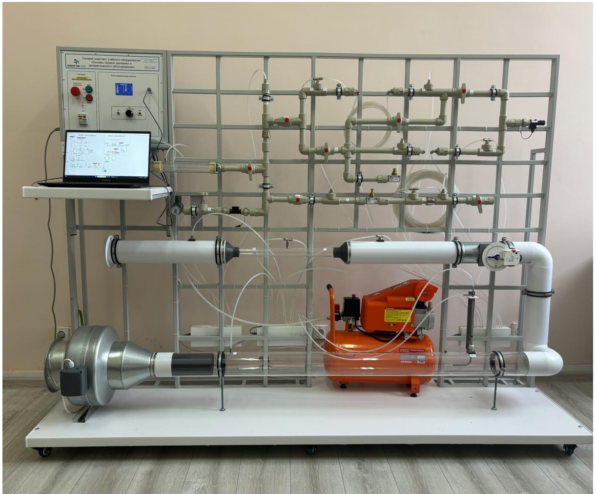
Лабораторный стенд "Магистральный транспорт природного газа"
