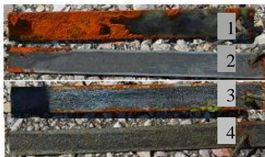
Рис. 2. Стальные пластины: 1 - контрольная, 2 - покрытая спиртовым янтарным лаком, 3 - покрытая масляным янтарным лаком, 4 - покрытая сначала спиртовым, а затем масляным янтарным лаком
