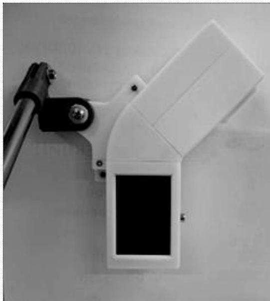
Рис. 3. Общий вид лазерного локатора
