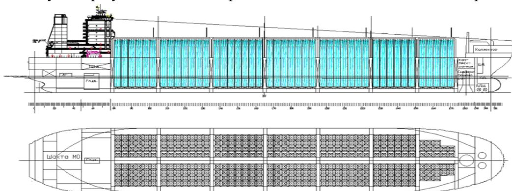
Рис. 1. Схема размещения цилиндрических грузовых баллонов на CNG-судне при установке их в вертикальном положении
