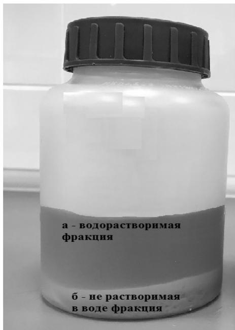
Рис. 1. Внешний вид двухфазной системы после центрифугирования:
