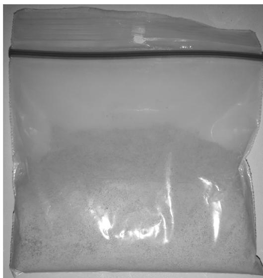
Рис. 6. Высушенная и измельченная осадочная фракция гидролизата
