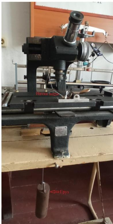
Рис. 1. Окулярный микроскоп с закрепленным образцом
