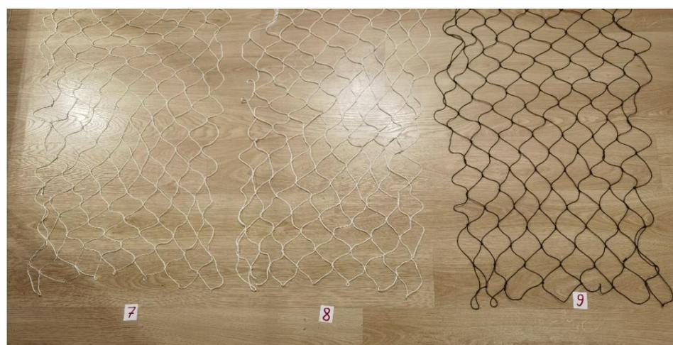
Рис. 4. Образцы сетных полотен с шагом ячеи 80 мм
