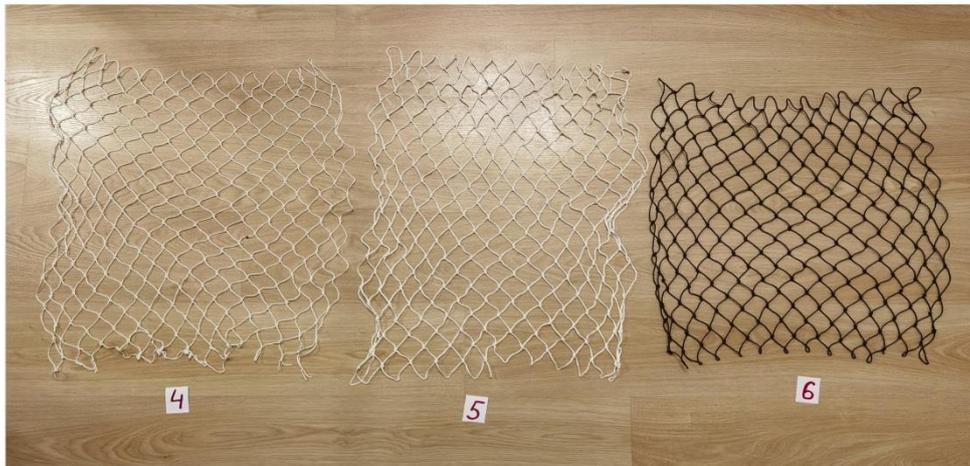
Рис. 2. Образцы сетных полотен с шагом ячеей 40 мм
