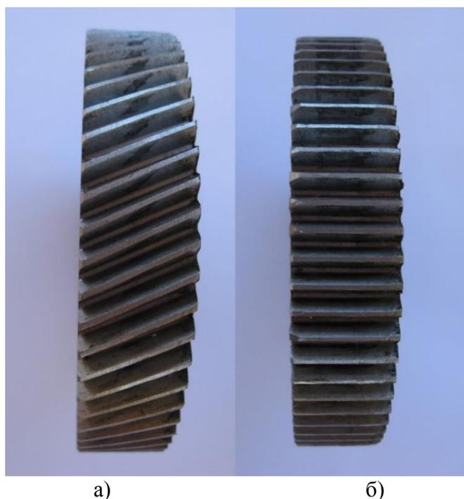
Рис. 1. Пятно контакта на зубьях винтовых зубчатых колес
