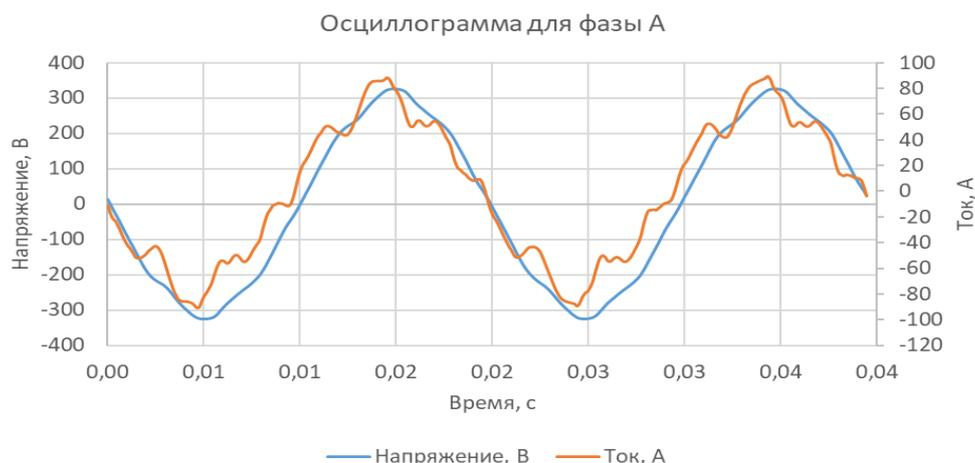
Рис. 4. Осциллограммы напряжения и тока в цепи низкой стороны трансформатора
