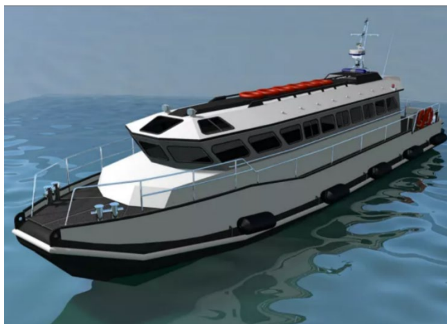
Рис. 3. Проект катера из ПНД длиной 19,5 м Fig. 3. Design of a HDPE boat with a length of 19.5 m
