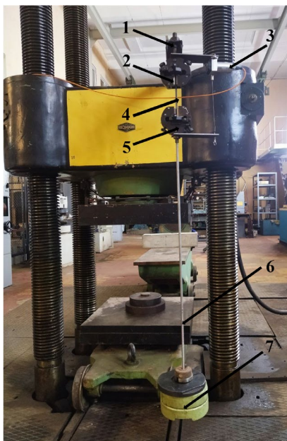
Рис. 6. Стенд для испытаний на ползучесть
