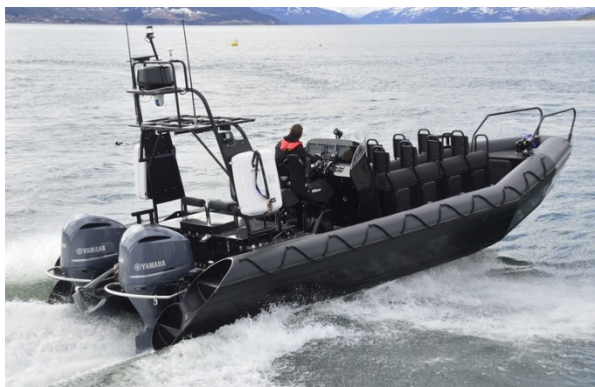
Рис. 1. Катер-риб из ПНД длиной 8,5 м Fig. 1. Rib boat made of HDPE with a length of 8.5 m
