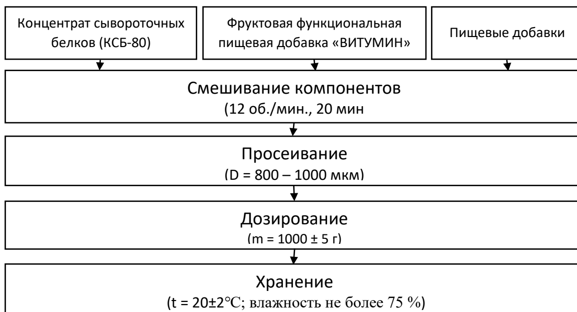
Рис. 3. Технологическая схема получения специализированного белково-углеводного напитка «BioCarb» в сухой форме Fig. 3. Technological scheme for obtaining a specialized protein-carbohydrate drink "BioCarb" in a dry form
