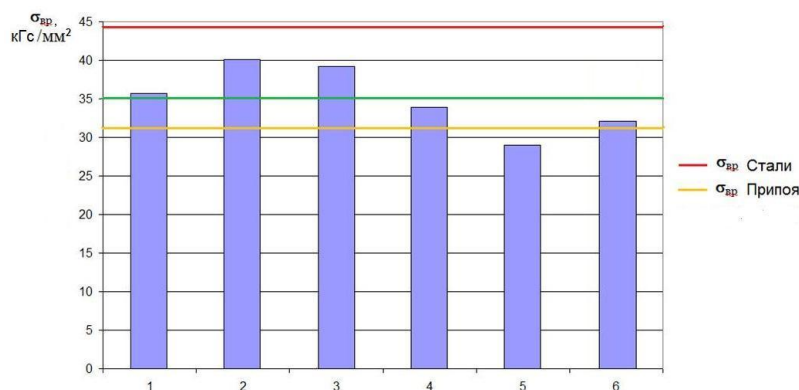
Рис. 4. Сводный график испытаний на разрыв образцов, полученных пайкой латунью Л63
