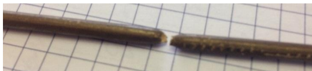
Рис. 1. Внешний вид разрушенного образца припоя из латуни Л63 Fig. 1. Broken sample with brass solder L63
