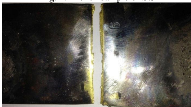
Рис. 3. Внешний вид разрушенного паянного образца Fig. 3. Broken soldered sample
