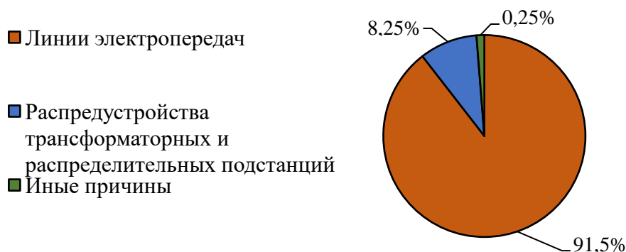
Рисунок 1 – Причины аварийности в электрических сетях
