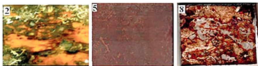
Рисунок 1 – Демонстрация метода на опытовых пластинах: 2 – пластина, извлеченная из воды (3 мес. в воде); 5 – механическая обработка пластины (1 мес. в воде); 8 – механическая обработка пластины (3 мес. в воде) [2]
