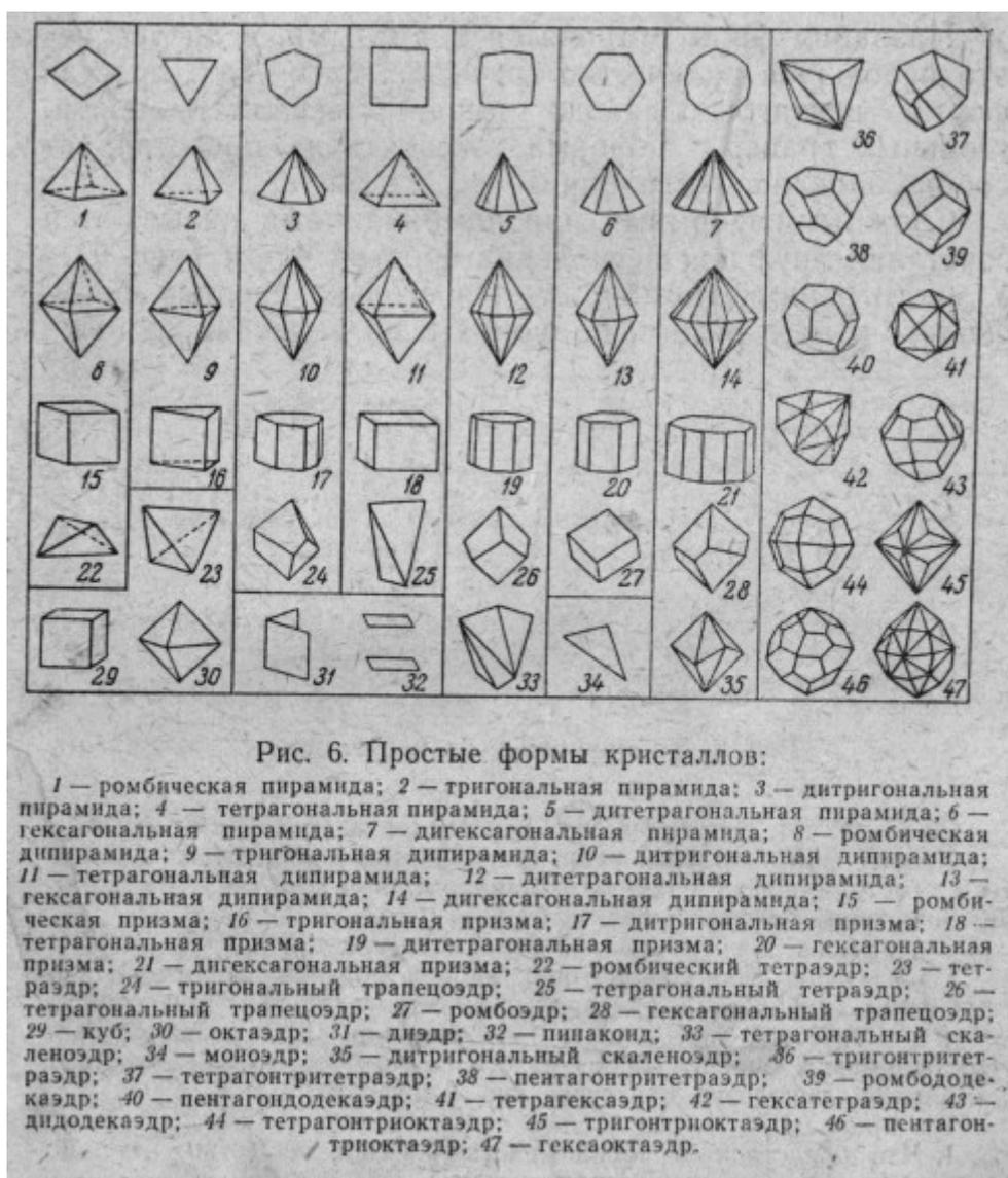
Рисунок 3 – Простые формы кристаллов
