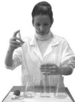
Рисунок 29 – Положение рук во время колориметрирования проб в парных цилиндрах
