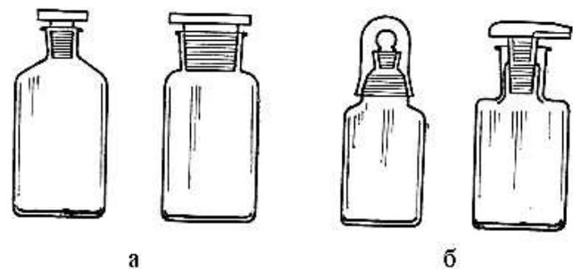
Рисунок 10 – Емкости для хранения реактивов (а – банки, б – кислородные склянки)
