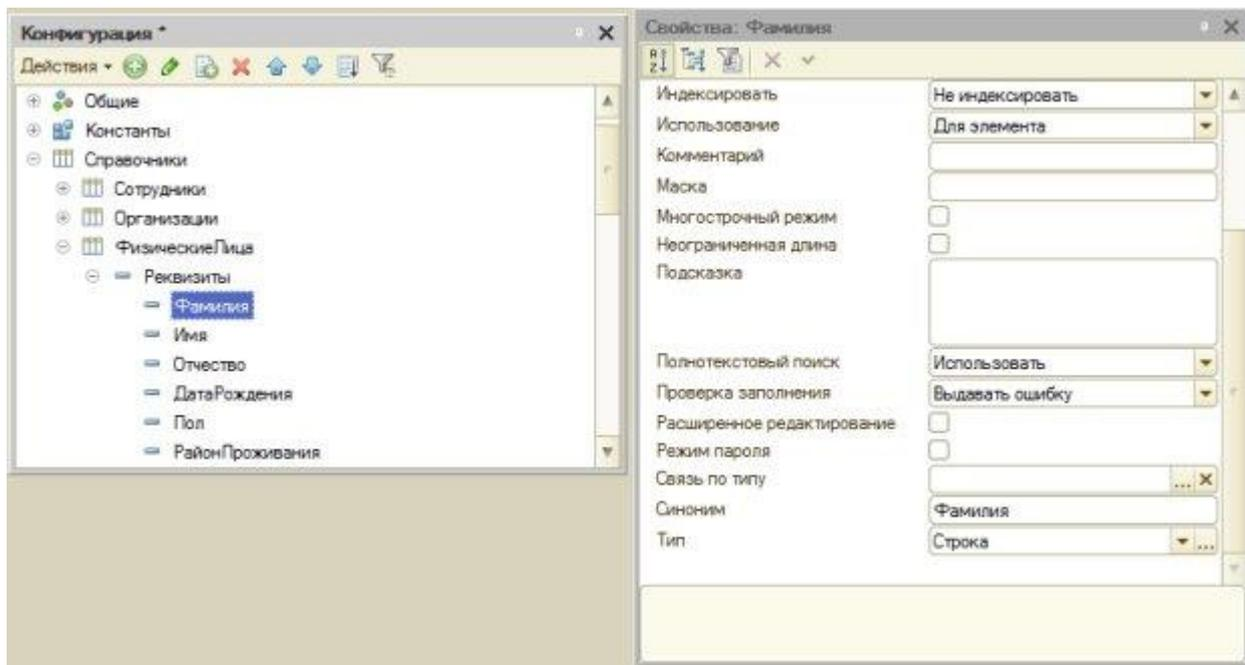
**Рисунок 2.20.** Настройка проверки заполнения
