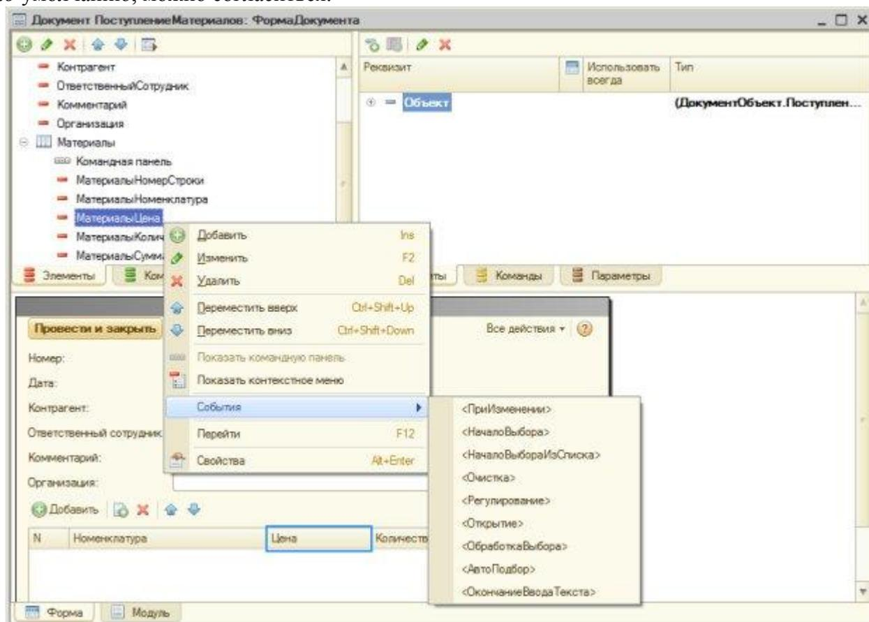
**Рисунок 6.6.** Назначение обработчика полю табличной части
