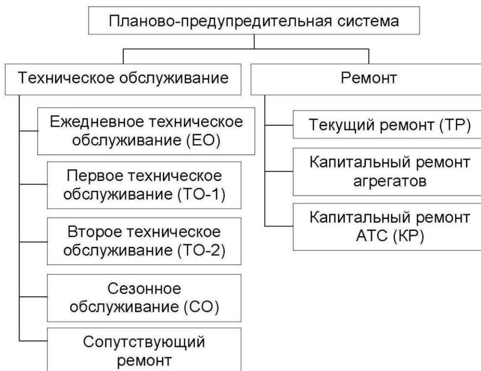
*Рис. 9. Схема работ, предусмотренных планово-предупредительной системой ТО и ремонта АТС российских конструкций*
