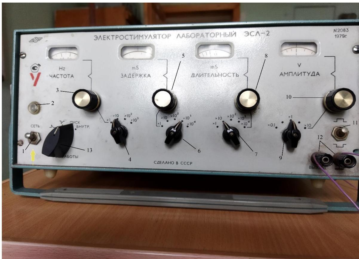
Рисунок 2 А - расположение органов управления на передней панели:
