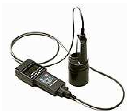
Рисунок 3.1 - Анализатор качества воды U-10
