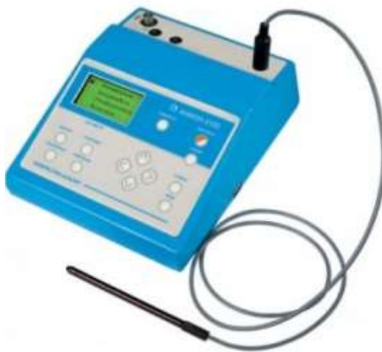
Рисунок 3.6 – Однопараметрический прибор АНИОН 4100
