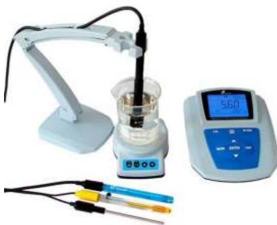
Рисунок 3.5 - Оксиметр лабораторный стационарный МР 525
