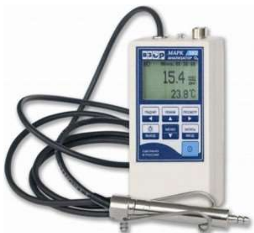
Рисунок 3.2 – Портативный оксиметр MARK-303T
