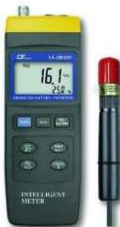
Рисунок 3.3 - Оксиметр и рН-метр YK-2001DO
