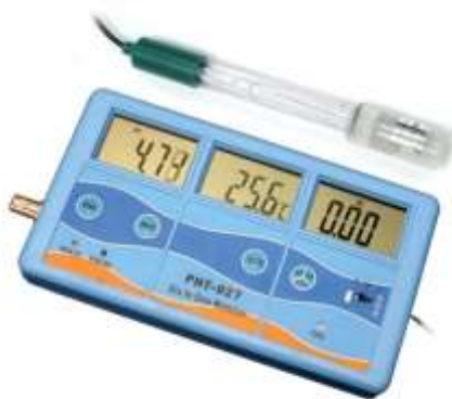
Рисунок 2.2 – Стационарный кондуктометр РНТ-027
