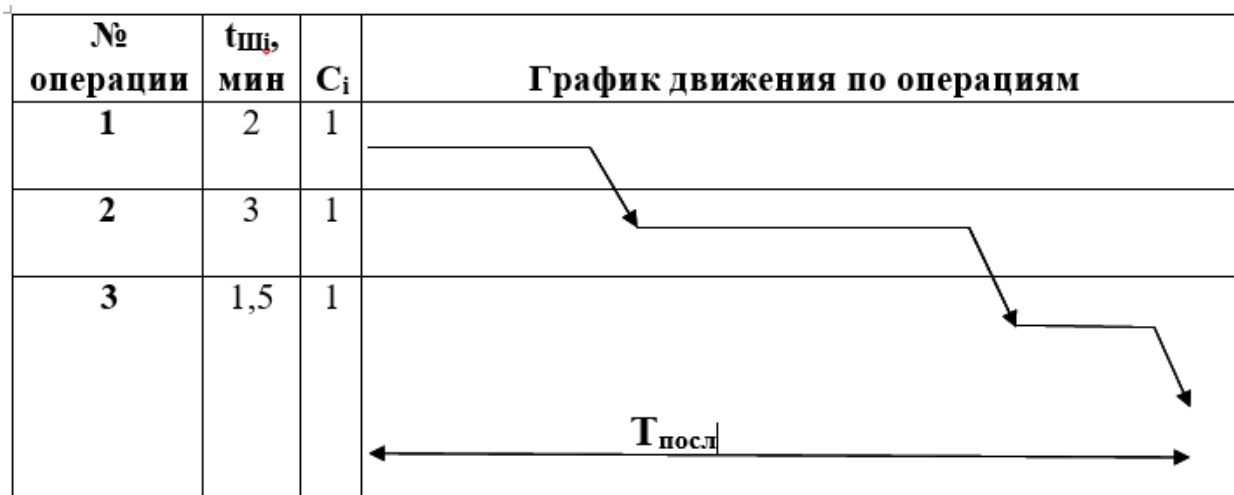
Рисунок 12 – График цикла при последовательном виде движения партии в производстве ( n = 15 шт., t_{мо} = 1 мин)
