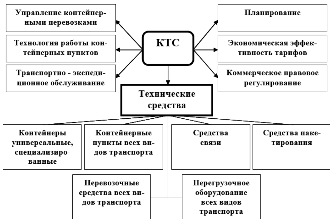
Рисунок 6 - Основные элементы контейнерных транспортных систем
