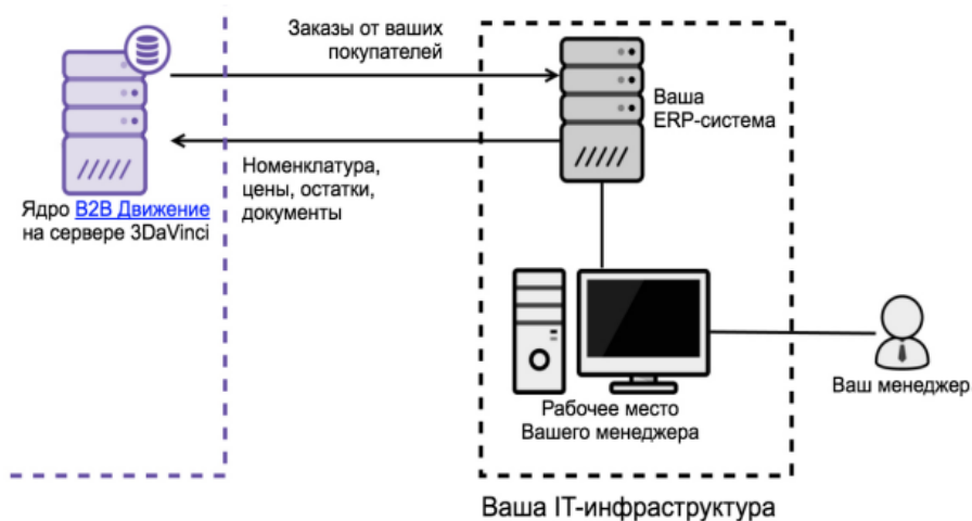
Рисунок 15 – Схема интеграции В2В-платформы с сервером
