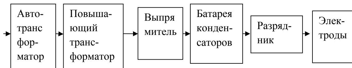
Рис. 7.4 Функциональная схема генератора импульсов
