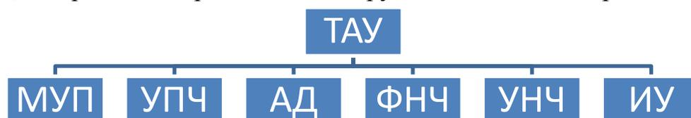
Рис. 2.1. Блок-схема ультразвукового течеискателя ТАУ-3:
