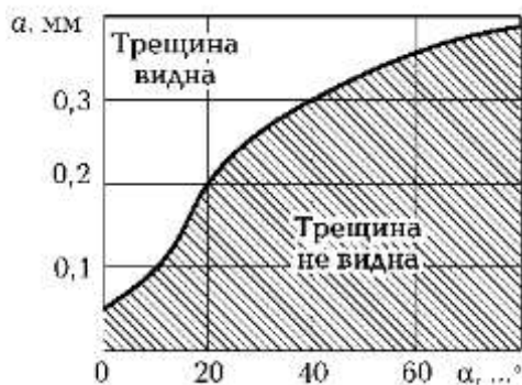
Рис. 2.4. Зависимость возможности выявления трещины шириной a и длиной b мм от угла \alpha ее отклонения от направления распространения излучения
