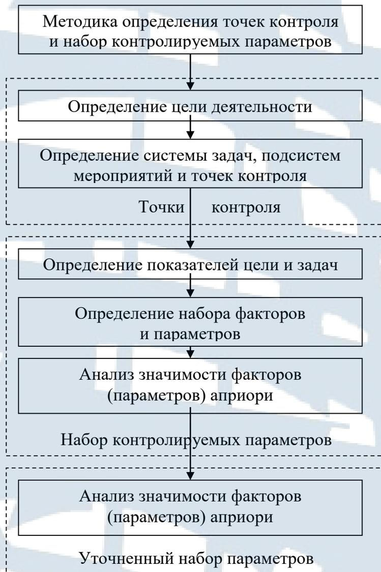
*Рис. 4.3.1. Определение точек контроля и контролируемых параметров качества*
