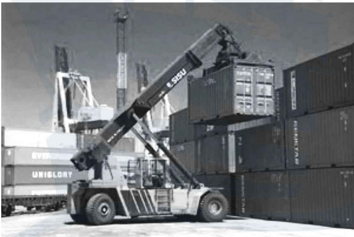
Рис. 142. Погрузка контейнера ричстакером
