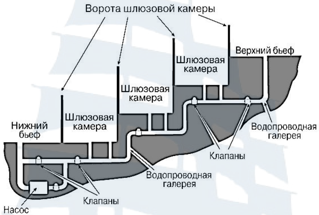
Рис. 92. Схема многокамерного шлюза с распределительной системой питания
