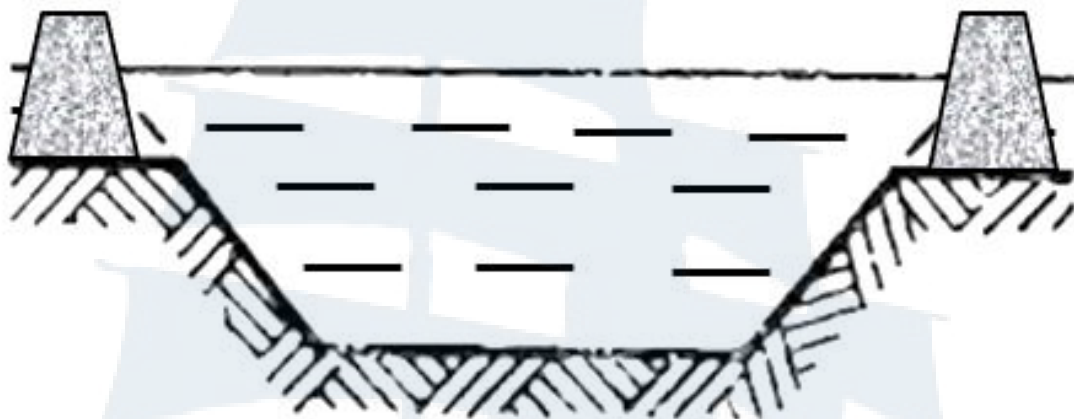
Рис. 26. Канал полного профиля, огражденный дамбами
