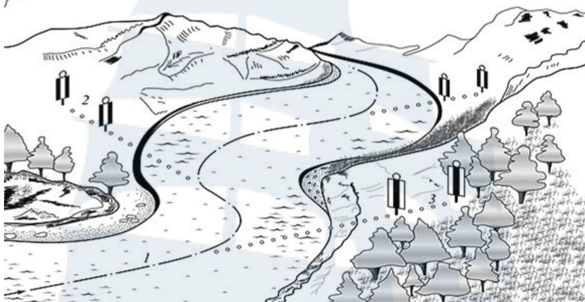
Рис. 42. Схема расположения осевых створов на участке реки: 1 – ось судового хода; 2 – створы на светлом фоне; 3 – створы на темном фоне
