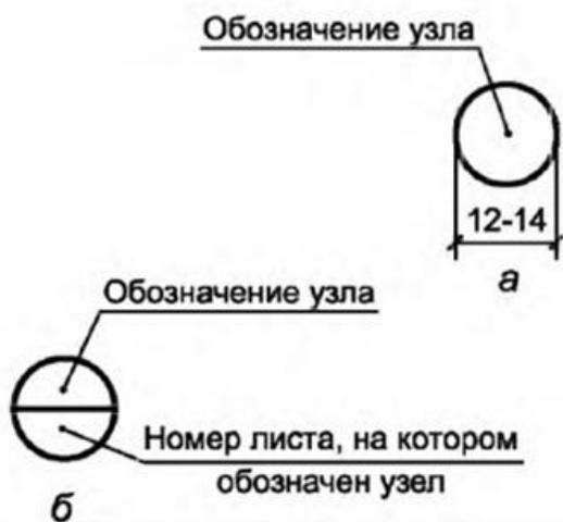
Рисунок 12 - Обозначение номера узла:
