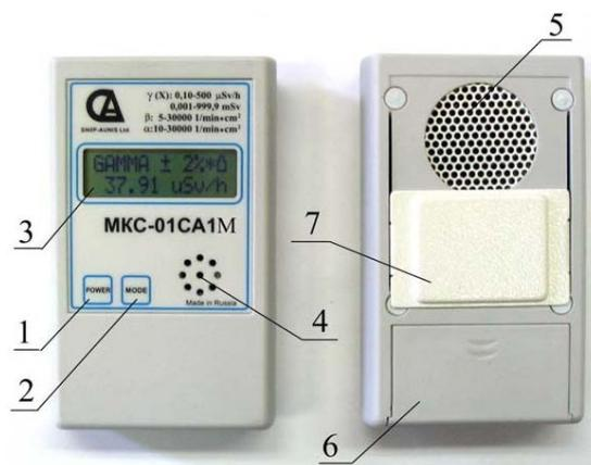
Рис. П.7.3.1. Внешний вид прибора и его элементы
