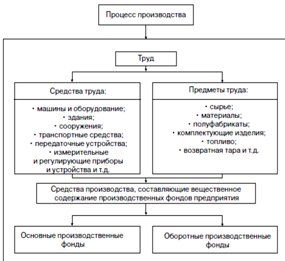
Рисунок 1.3 – Характеристика факторов процесса производства
