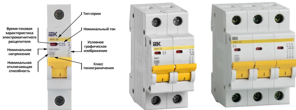
Рисунок 3.1 – Внешний вид воздушного автоматического выключателя при числе полюсов от одного до трех
