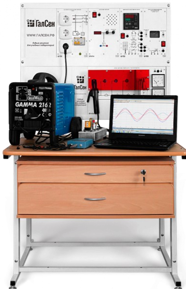
Рисунок 1 – Внешний вид лабораторного стенда «Электротехнологические системы и установки»
