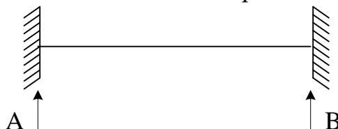
Рис. 2.4. Расчетная схема шинной конструкции
