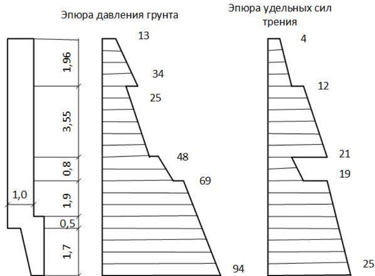
Рисунок 2.17. Эпюры давления грунта и удельных сил трения
