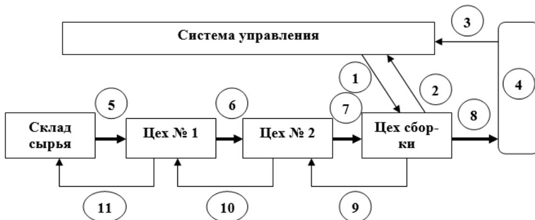
Рисунок 10 - Принципиальная схема тянущей системы:
