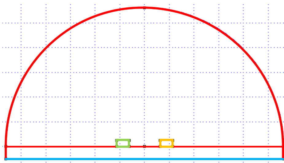
Рисунок 2.9 – Граничные условия. Красным цветом отмечены внешние границы, синим – линия нулевого потенциала, зелёным – проводник с положительным потенциалом, оранжевым – проводник с отрицательным потенциалом
