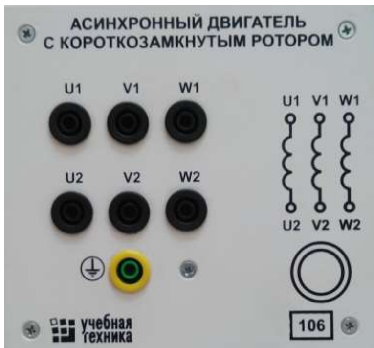
Рисунок 3.2 - Панель коммутации электродвигателя
