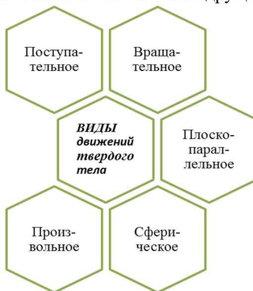
Рисунок 2 - Виды движений твердого тела
