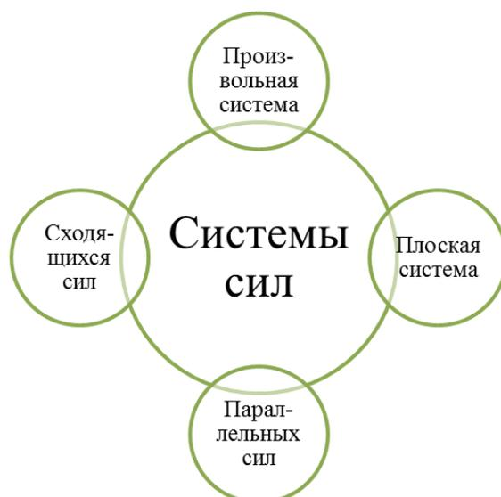
Рисунок 9 - Классификация сил по взаимному расположению линий их действия
