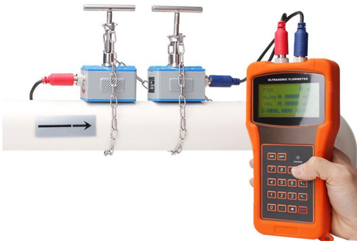
Рис. 47. Портативный ультразвуковой расходомер
