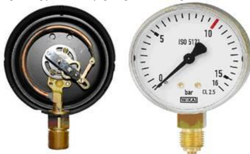
Рис. 57. Вид трубчато-пружинного манометра снаружи и изнутри
