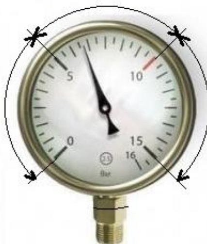
Рис. 84. Указание рабочего давления на манометре
