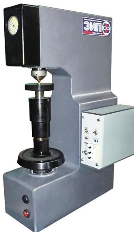
Рис. 24. Твердомер методом статического вдавливания
