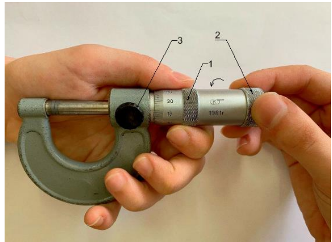
Рис. 27 – Установка барабана на нуль
