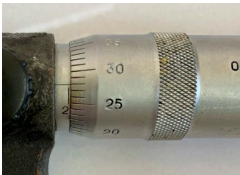
Рис. 25. Неправильная установка микрометра в нулевое положение
