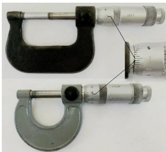
Рис. 23. Проверка нулевого положения микрометра
