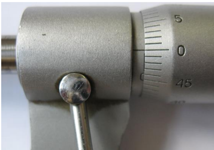
Рис. 24. Установка микрометра на нуль проведена правильно
