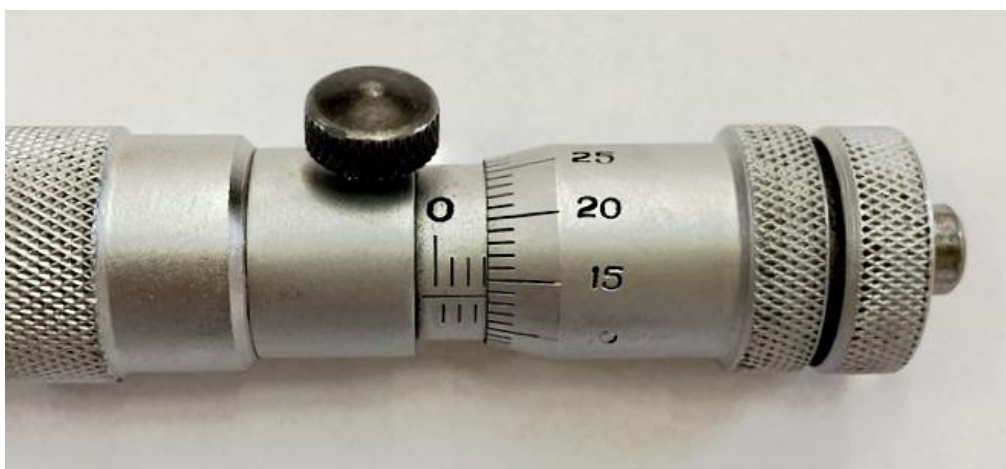
Рис. 37. Пример отсчёта по шкалам нутромера
